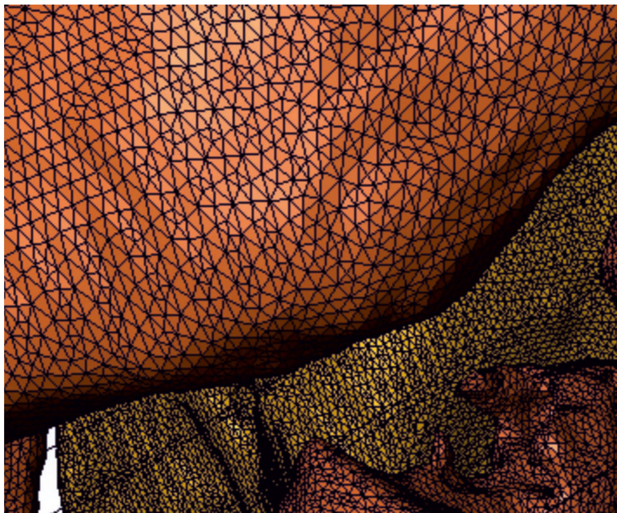
Ryc. 6. Widok powierzchniowej siatki trójkątów (format STL) opisującej model fragmentu kości czaszki (przedstawiony fragment w powiększeniu). Fig. 6. View of a surface triangle mesh (STL format) describing the model of a fragment of a skull (the fragment in close-up).
